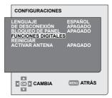
Seleccione la pestaña CARACTERISTICAS DIGITALES del menú CARACTERISTICAS mediante los botones de movimiento arriba/abajo y pulse el botón izquierda/derecha para confirmar. Aparecerá el menú CARACTERISTICAS DIGITALES.
