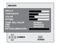
En él puede seleccionar la opción que desee ajustar. Puede seleccionar el valor deseado mediante los botones de movimiento **arriba/abajo** y ajustar sus niveles mediante los botones de movimiento **derecha/izquierda**. Puede ajustar a su gusto los niveles de **BRILLO, CONTRASTE, COLOR** y **NITIDEZ**.
